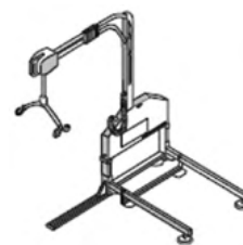
ベッド固定型リフト： 昇降軌道が鉛直なタイプ
